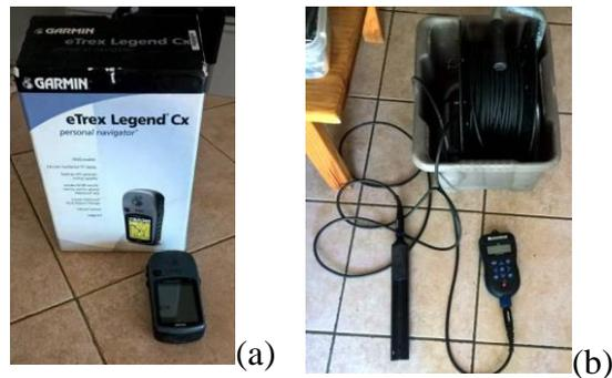
**Figure 6 : matériel utilisé GPS (a) ; sonde multi-paramètres (b)**
