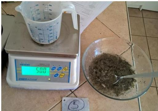
**Figure 8 : Réalisation d'un sous-échantillonnage de 50 g**
