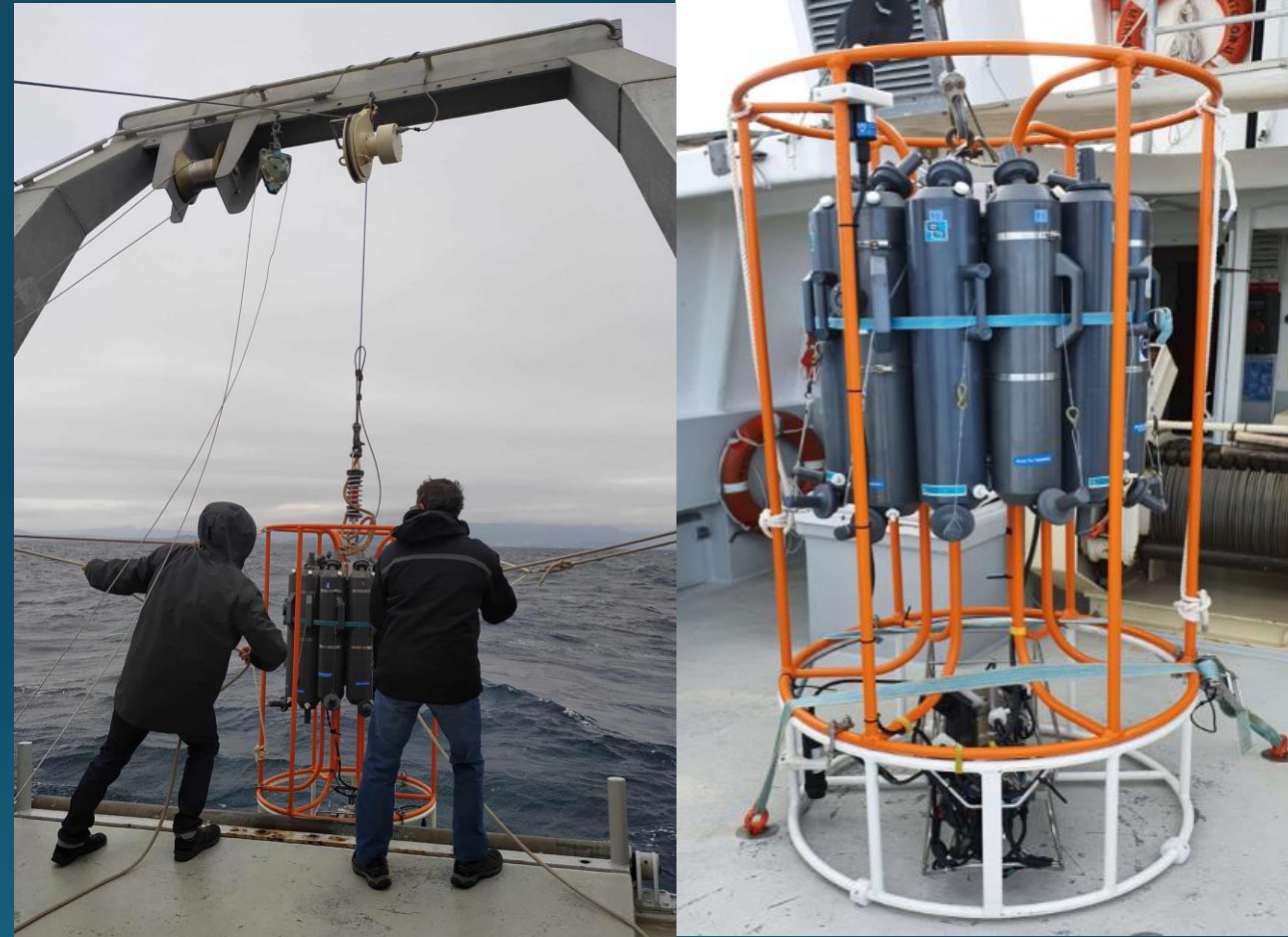
Illustration du déploiement d'une bathysonde ou CTD-Rosette (mission PHYOCE 2020)
