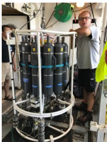
(a) Bouteilles Niskin montées sur rosette © IRD RUITTON Sandrine
