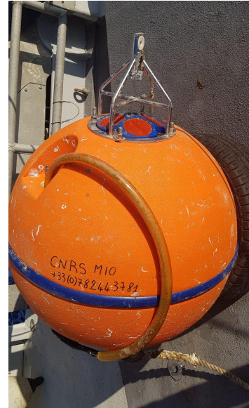
Figure 2 : Schéma général du fonctionnement d'un ADCP, et photographie de l'ADCP utilisé au mouillage JULIO, dans son flotteur, lors de sa dernière mise à l'eau le 07 décembre 2020 (Petrenko,2020).
