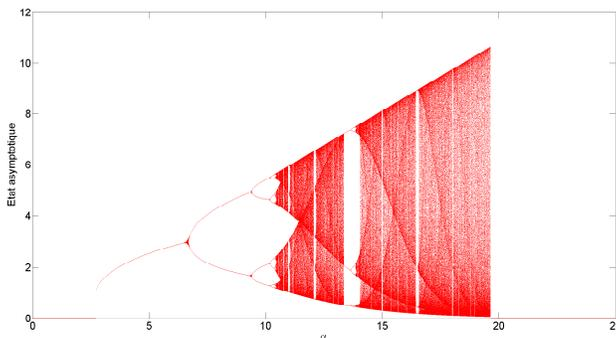
FIGURE 1 – Diagramme de bifurcation du modèle (1) lorsque le paramètre  $\alpha$  varie de 0 à 25 avec  $\beta = 1$ .
