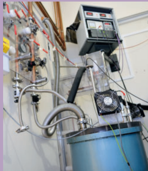
>>> Dispositif d'une expérience sous champs magnétiques pulsés. L'aimant se trouve dans un bain d'azote liquide (récepteur bleu). ©CNRS/Cyril Fréssillon
