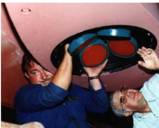
Figure 3 : Photo de la mise en place d'un ADCP sous la coque d'un bateau.
