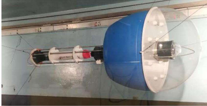
FIGURE 5 – Photo du VVP en soufflerie, avec la carène (partie bleue) et la bulle (dôme transparent) [3].
