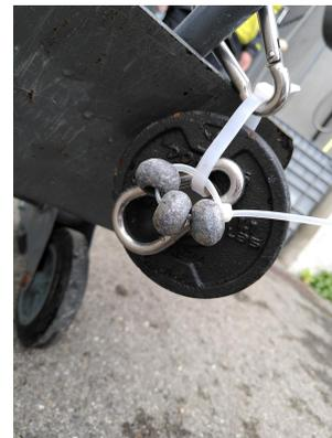
FIGURE 8 – Photographie d'un exemple de ballast (poids qui peut être installé sur le VVP). Ici un disque de 450g dans l'eau et des plombs de 32g dans l'eau chacun.
