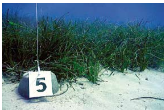
Balise installée le long de la limite inférieure de l'herbier des îles Kerkennah (Tunisie) dans le cadre du programme MedPosidonia (PNUE-PAM-CAR/ASP, 2009b)
