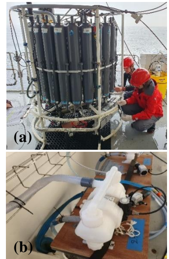
Figure 4 – Outils utilisés lors de la campagne pour la collecte de microorganismes. (a) Carrousel. (b) Système de pompage. Crédit : Grégori G.
