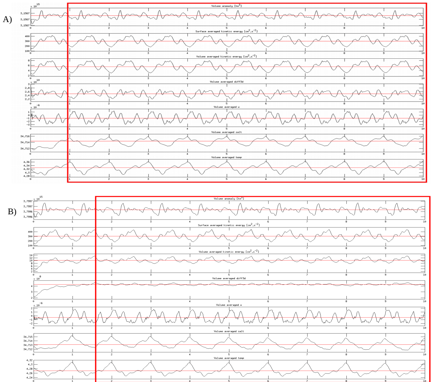
Figure 2 : Diagnostic de la simulation A) à 1/3 B) à 1/15. De haut en bas, le volume total (km³), l'énergie cinétique moyennée sur le surface (m²s⁻²), l'énergie cinétique moyennée sur le volume (m²s⁻²), la vitesse verticale moyennée sur le volume, la salinité moyennée sur le volume, la température moyennée sur le volume.
