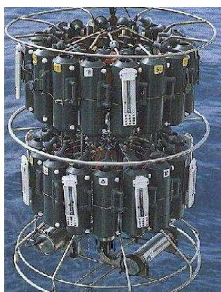
Une rosette est un ensemble de bouteilles de prélevement montés sur un châssis permettant de prélever à différentes profondeurs de l'eau de mer pour en mesurer les caractéristiques ( $T^\circ\text{C}$ , Salinité, pH, sels nutritifs, ...).
