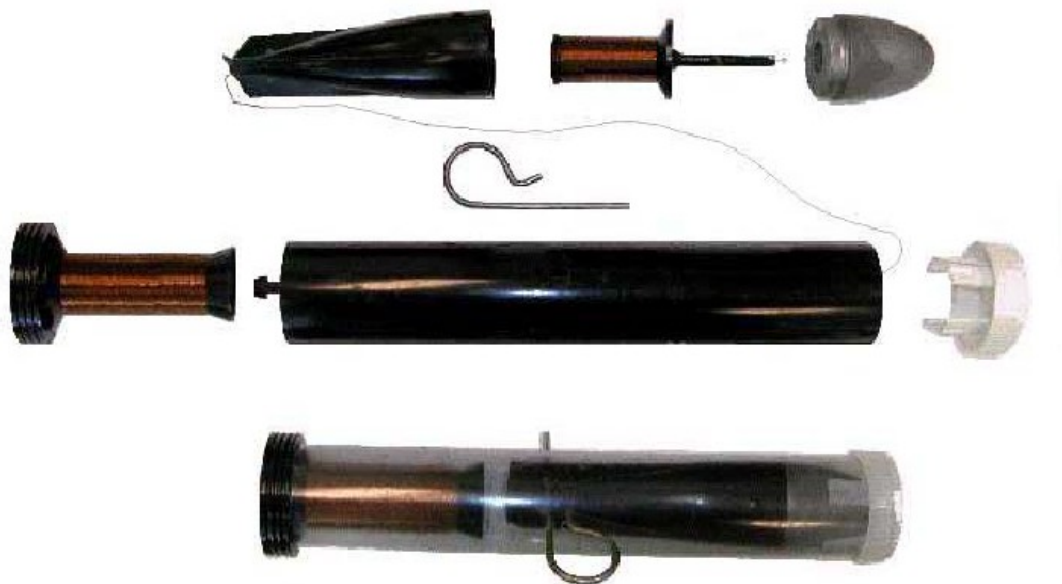
Figure : Sondes XBT : En haut éclaté d'une douille avec sa sonde, en bas ensemble monté
