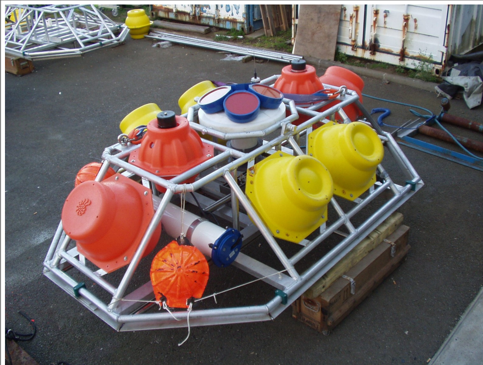
Exemple de mouillage de fond (Ifremer, Ecolophy 2005) avec flotteurs pour remonter à la surface
