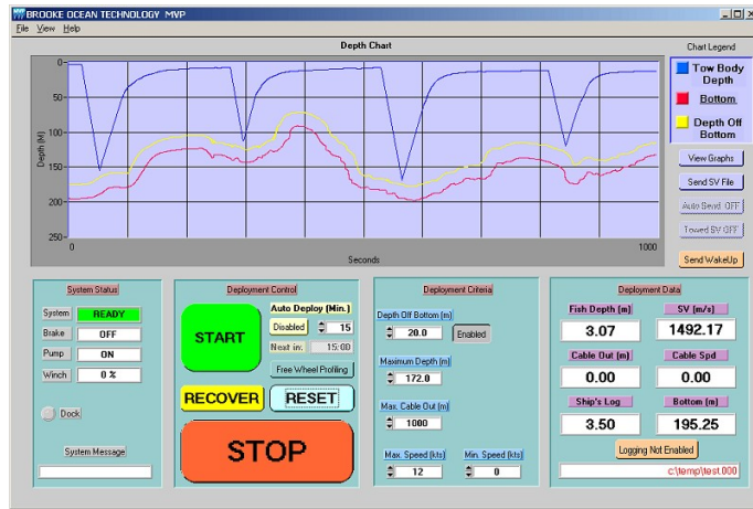
(b) Exemple d'affichage des données en temps réel - ©ODIM Brooke Ocean.
