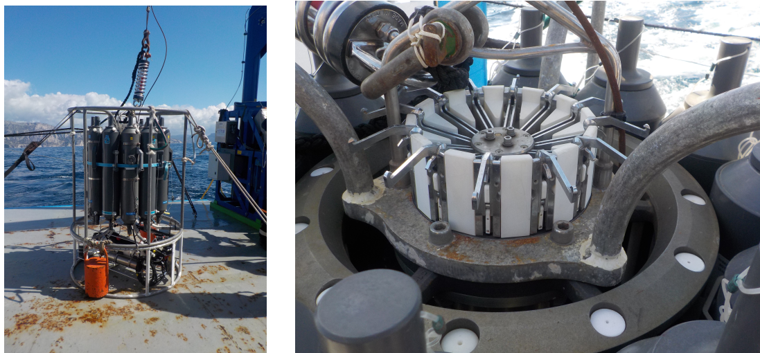
FIGURE 6 – La bathysonde et son système de déclenchement de fermeture des bouteilles - ©Étudiant OPB 2017.
