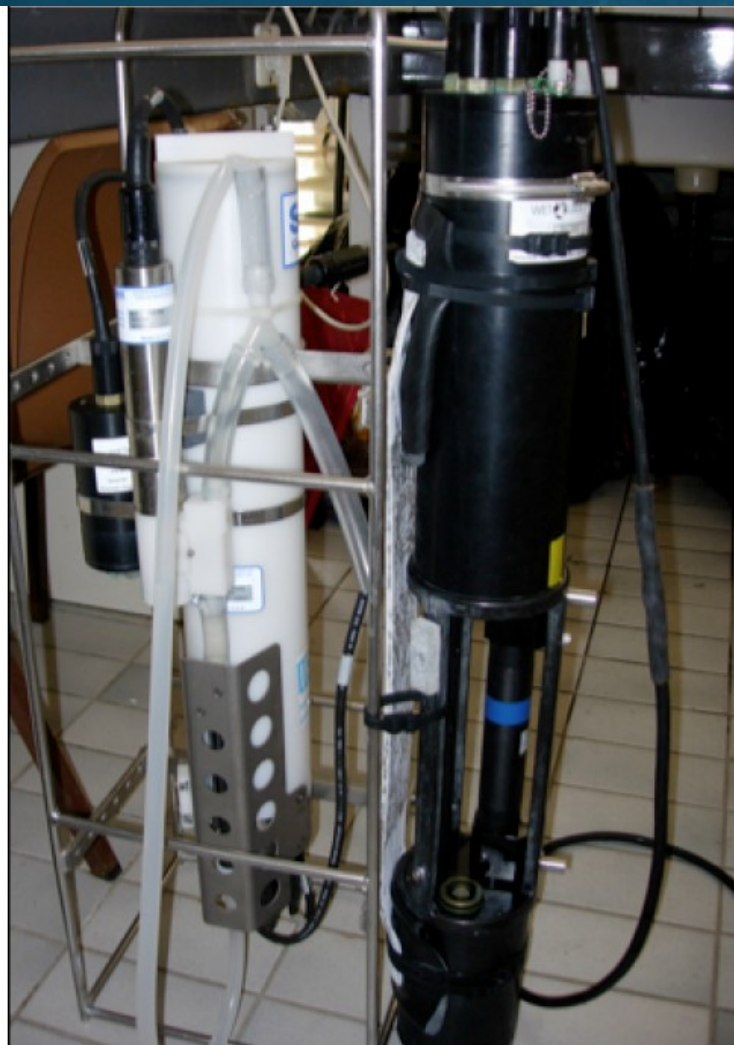
AC 9 « Absorption and attenuation meter » à 9 longueurs d'onde (WETLabs)
