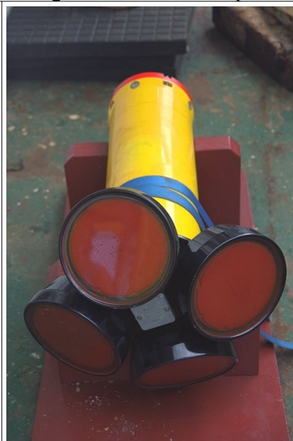
b) courantomètre acoustique à effet doppler (ADCP)
